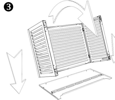
Retourner le coffre et le positionner sur le capot
