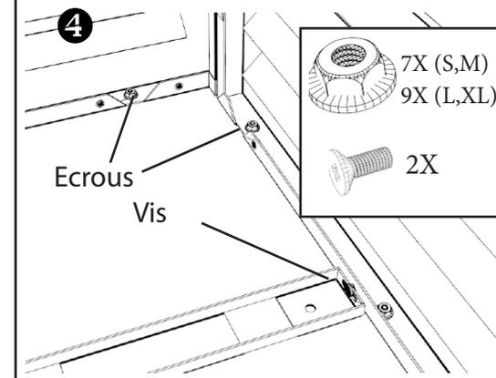
Utiliser les vis et écrous pour fixer le capot
